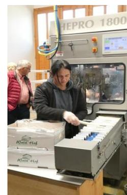
Befüllen der Spargelschälmaschine
